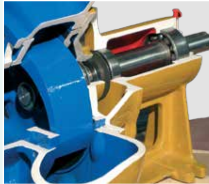
Gehäuse mit Verschleißplatte, offenes Laufrad
