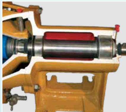
einfachwirkende Gleitringdichtung von außen geschmiert
